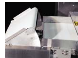
Delbart ut-transportbånd: Automatisk utkast av tomme pakker.
