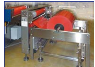
Jumbo Underfilmlulloppheng direkte for maskinen, Rullediameter: 1000 mm
