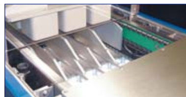
Pneumatisk betjente pakkeunderstøttingskinner i inn- og utløp, bli tilpasset til pakkestørrelser ved en valgbryter, ingen omstillingstid!
