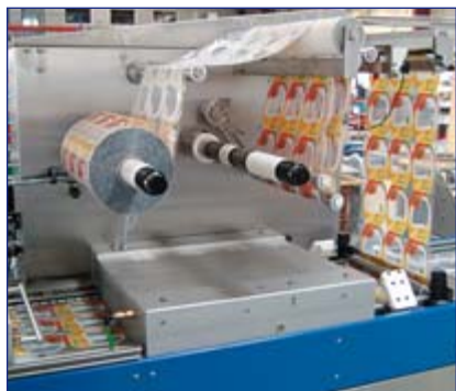
Overfilmeheftestasjon Patent No. DE 101 54 711.0 for enkel og nøyaktig innkjøring av en ny overfilm, anbefales spesielt ved fotocelleregistrert film. Dobbelt overfilmmottak gir kortere stopptid.
