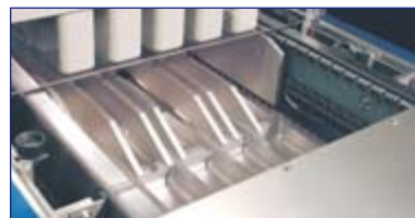
Pneumatisk betjente pakkeunderstøttingskinner i inn- og utløp, bli tilpasset til pakkestørrelser ved en valgbryter, ingen omstillingstid!
