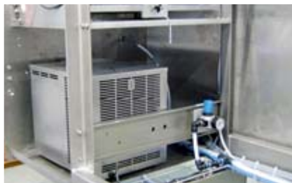
Vannkretsløpskjøling montert, ingen vanntilkobling nødvendig, ingen vannforbruk
