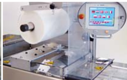
Patentert overfilmheftestasjon (valgfritt), anbefales ved måltrykt overfilm
