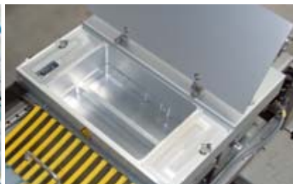
Øvre formverktøy med forvarming og deksel som kan slås opp slik at man kan bytte formverktøyene fortere (valgfritt)
