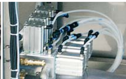
Ventilblokk med Festo standardsylindere
