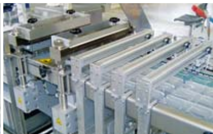
Kombinasjon av flere tværrutterer på en Primus
